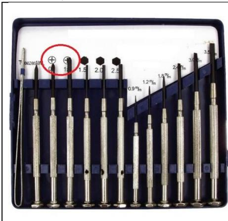
No tienen nada de peligro, pero al tocar el potenciómetro con estos destornilladores, genera mucho ruido por interferencia y aparte de ser molesto, no dejará escuchar bien la calibración, así que aislarlos ayuda a reducir el ruido.
